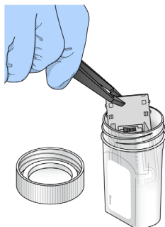
図 5 MiSeqDx フローセルの取り出し
