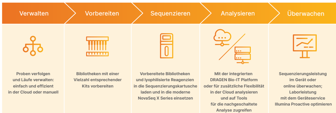
Abbildung 4: Intuitiver und optimierter Workflow für die Hochdurchsatzsequenzierung: Die Sequenziersysteme NovaSeq X und NovaSeq X Plus bieten einen umfassenden Workflow mit anwenderfreundlicher Laufkonfiguration, einem breiten Spektrum an kompatiblen Bibliotheksvorbereitungskits und integrierter Sekundäranalyse. Zudem wird die Geräteleistung proaktiv überwacht.
