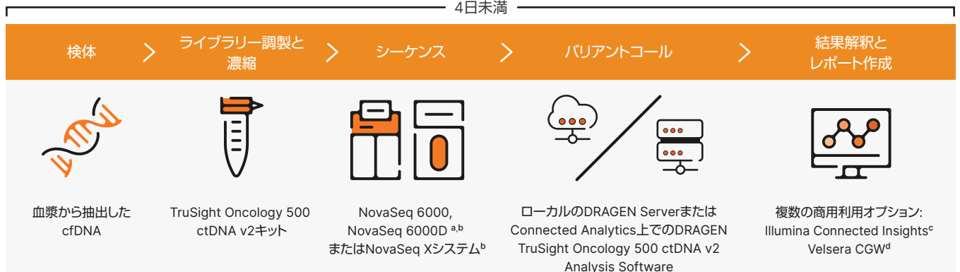
図2:TruSight Oncology 500 ctDNA v2のワークフロー:TruSight Oncology 500 ctDNA v2はラボの既存のワークフローに統合でき、cfDNAからバリエーションレポート作成まで4日間未満で完了します。DRAGEN TruSight Oncology 500 ctDNA Analysis Softwareは、DRAGEN Server上でローカルで実行するか、Illumina Connected Analyticsを介してクラウドで実行します。a. NovaSeq 6000Dx (RUOモード)。b. 2024年に利用可能になります。c. すべての国で利用可能とは限りません。Illumina Connected Insightsは、サードパーティーのナレッジソースへのAPIコールを通じてユーザー定義の三次解析に対応します。d. Velsera社の旧称はPierian社です。他の商用オプションも利用できます。
