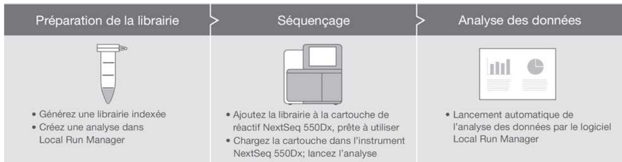
**Figure 2 : Processus de réalisation de tests en trois étapes NextSeq 550Dx** – L'instrument NextSeq 550Dx fait partie d'un flux de travail intégré en trois étapes. Des rapports de résultats détaillés sont disponibles avec le test d'amplicons personnalisés TruSeq<sup>MC</sup> Dx.
