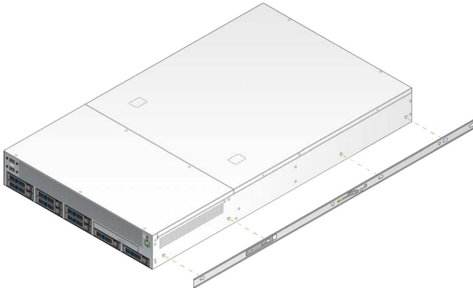
4. Ripetere l'operazione per fissare la staffa di montaggio sull'altro lato.
