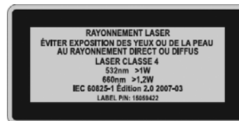
Figure 2 Mise en garde laser de classe 4
