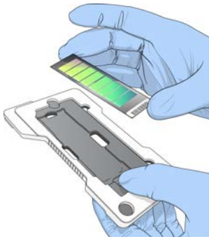
Figura 19 Carga del BeadChip en el adaptador
