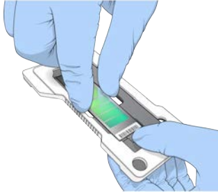
Figura 20 Colocación y fijación del BeadChip
