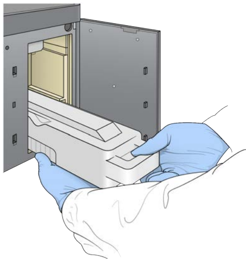
Figura 14 Extracción del contenedor de reactivos usados
