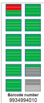
Kuva 28 BeadChip, jossa näkyy epäonnistuneita osia
