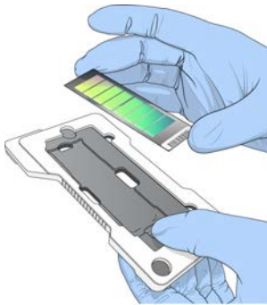
Figure 19 Charger la puce BeadChip dans l'adaptateur
