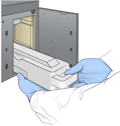
Figure 14 Retirer le réservoir à réactifs usagés
