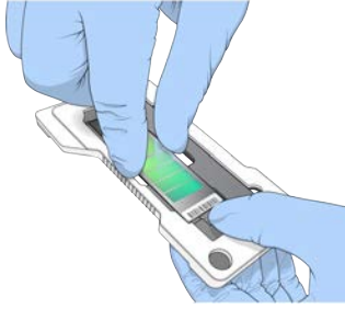
Figure 20 Positionner et fixer la puce BeadChip
